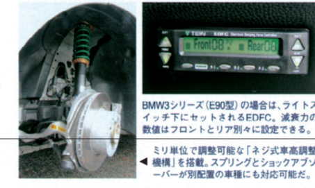
BMW3シリーズ(E90型)の場合は、ライトスイッチ下にセットされるEDFC。減衰力の数値はフロントとリア別々に設定できる。
