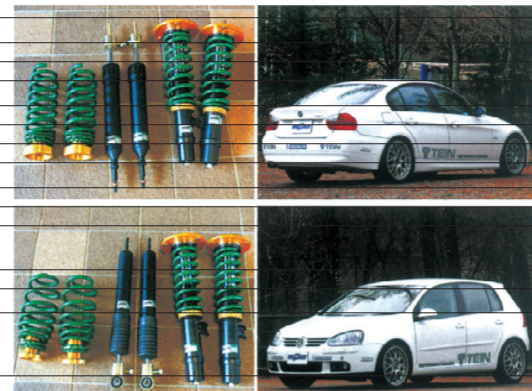
撮影車両のBMW320i、VWゴルフ5GTIは共に純正16インチホイールからBBSの18インチホイールに、タイヤの扁平率も55から40に変更されている。車高は純正から約3cm下げた状態での試乗だった
