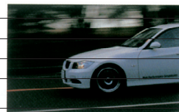
320iはフロントバネレートは5kgf/mmにアップされているが、リアは6.7kgf/mmと純正の08.8kgf/mmよりダウンされている
