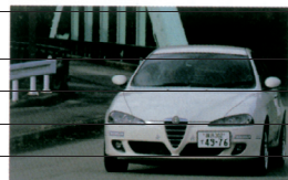
フロントにダブルウィッシュボーンを持つアルファ147TT12.0ツインスパーク。バネレートはフロント5.0kgf/mm、リア2.5kgf/mm。前後とも215/45-17サイズを履く
